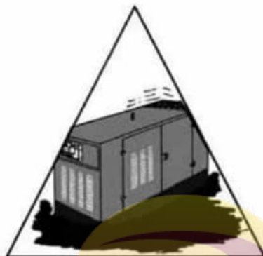
Неровное или недостаточно жесткое основание. Генератор установлен неправильно.
