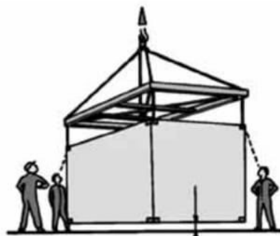
Проверка крепления после того, как контейнер оторвался от земли
